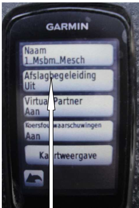
zet afslagbegeleiding "AAN"
